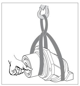
Abb. 5: Transport mit Hebeband
