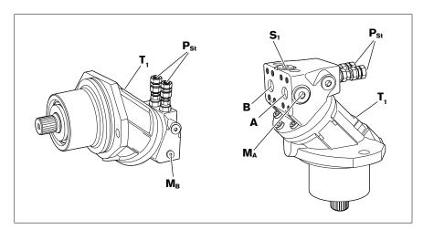
Abb. 13: Anschlussübersicht A2FE, Nenngröße 28 bis 180, Anschlussplatte 192 mit Druckbegrenzungsventilen, Arbeitsanschlüsse unten
