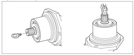
Abb. 4: Befestigung der Ringschraube
