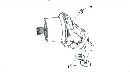
Abb. 1: Axialkolbeneinheit mit Arbeitsanschlüssen unten
