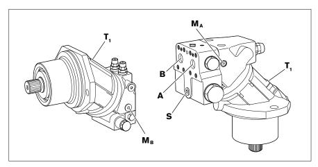
Abb. 14: Anschlussübersicht A2FE, Nenngröße 28 bis 180, Anschlussplatte 181 mit angebautem Bremsventil, Arbeitsanschlüsse unten
