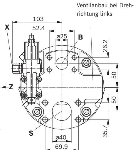
Ventilanbau bei Drehrichtung links
