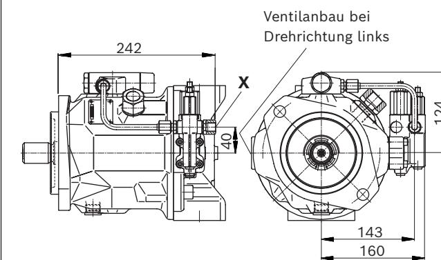
▼ ED7. / ER7. – Elektro-hydraulische Druckregelung
