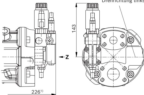
▼ ED7. / ER7. – Elektro-hydraulische Druckregelung
