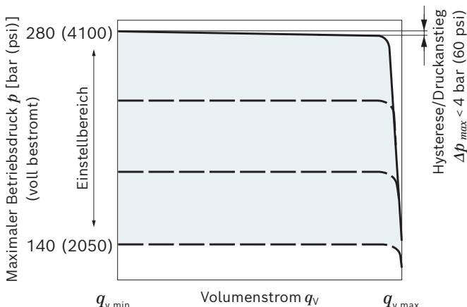
Kennlinien gültig bei  $n_1 = 1500 \text{ min}^{-1}$  (rpm)
