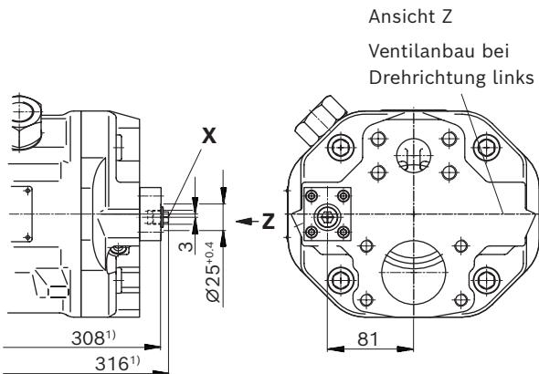
▼ DG – Zweipunktverstellung, direktgesteuert
