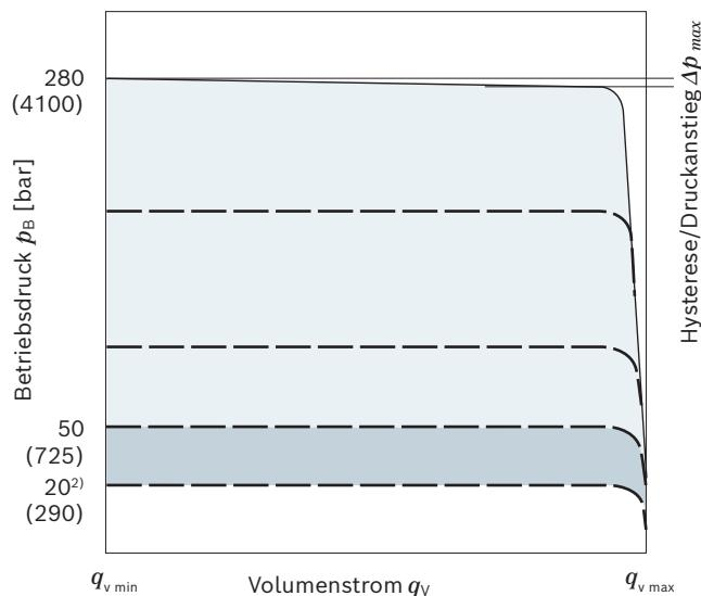
Kennlinie gültig bei  $n_1 = 1500 \text{ min}^{-1}$  und  $\vartheta_{\text{fluid}} = 50^\circ \text{C}$  ( $120^\circ \text{F}$ ).
