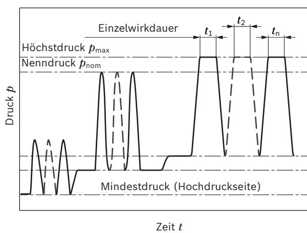
$$\text{Gesamtwirkdauer} = t_1 + t_2 + \dots + t_n$$
