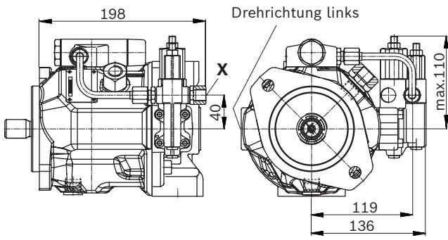
▼ ED7. / ER7. – Elektro-hydraulische Druckregelung
