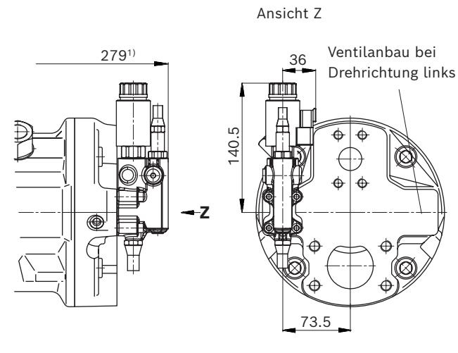
▼ EC4/EB4 – Elektrohydraulisches Regelventil
