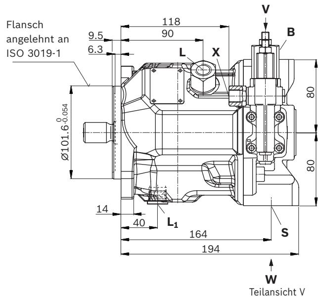
Ventilanbau bei Drehrichtung links
