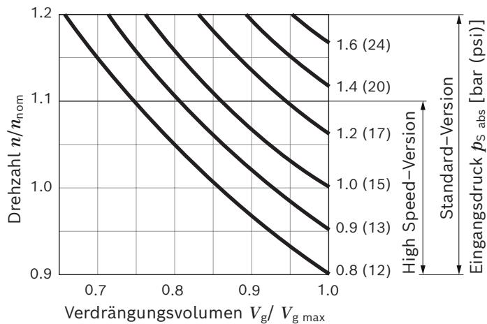
Bei Dauerbetrieb in Überdrehzahl über  $n_{\text{nom}}$  ist eine Lebensdauerreduzierung aufgrund von Kavitationserosion zu erwarten.
