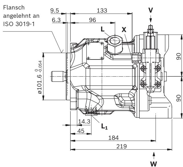
Ventilanbau bei Drehrichtung links
