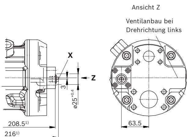
▼ DG – Zweipunktverstellung, direktgesteuert
