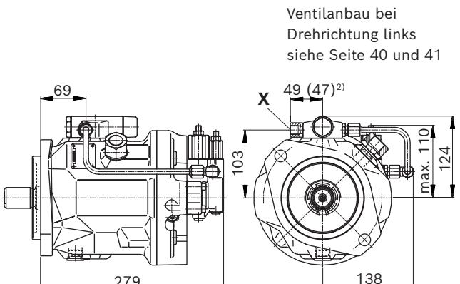
▼ ED7. / ER7. – Elektro-hydraulische Druckregelung
